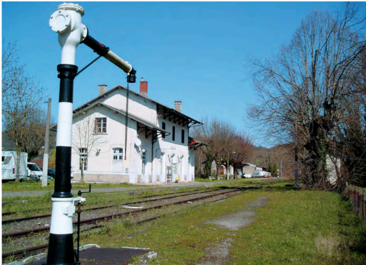
La gare de Cajarc sous le soleil. Au premier plan, la grue hydraulique qui réapprovisionnait en eau les machines à vapeur. Classée aux Monuments historiques, elle a été restaurée par Quercyrail.
